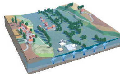
Inondation de nappe
